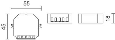
Funk-2-fach-Sendemodul. Mit innenliegender Antenne.
